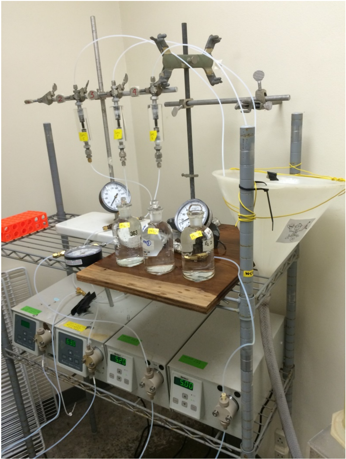
Figure 13: Actual RSSCT Test Apparatus
